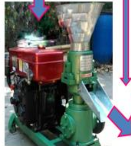
Mesin Pembuat Pellet (pakan ikan/itik)
