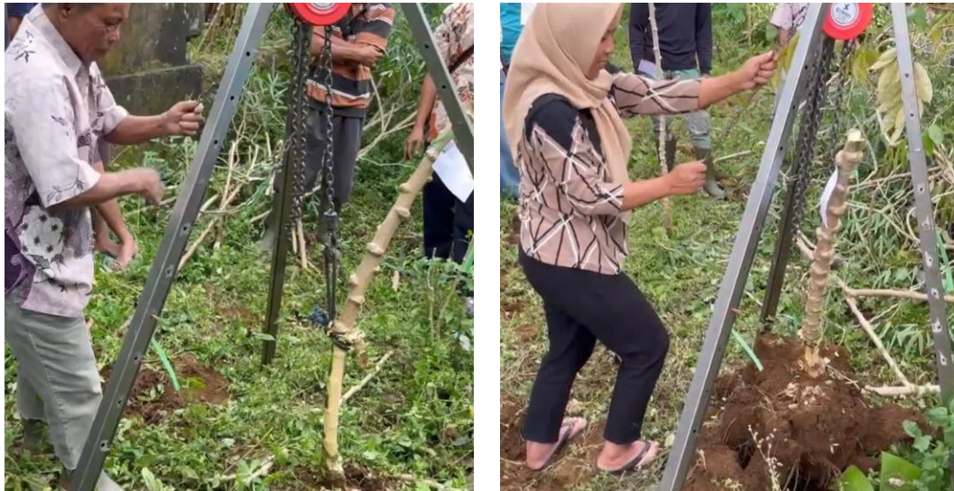
Gambar 6. Pemanenan dengan alat katrol oleh petani laki-laki dengan keterbatasan tenaga kerja (kiri) dan oleh petani perempuan (kanan)
