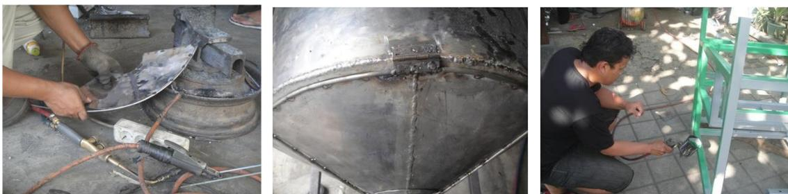
Gambar 2. Proses Manufaktur mesin peniris minyak abon
