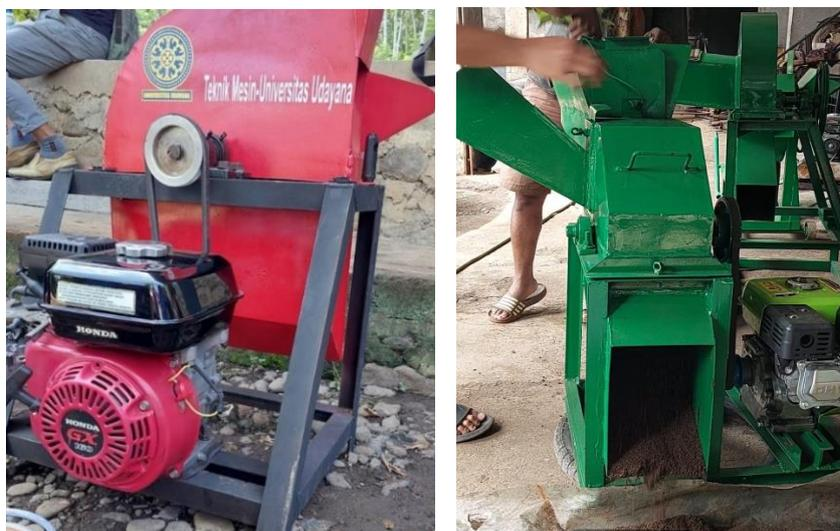
Gambar 1. Mesin pencacah kompos dan pemotong pakan ternak
